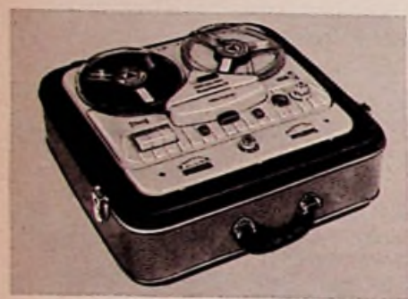
Bild 1. Das Magnetophon 85 Stereo. Es besitzt zwei Geschwindigkeiten 9,5 und 19 cm und einen Frequenzgang von 30...20 000 Hz bei 19 cm/sec Bandgeschwindigkeit. Das Gerät ist neben einkanaltiger Aufnahme/Wiedergabe auch für stereofone Wiedergabe eingerichtet. Es verfügt über zwei unabhängige Transistor-Stereo-Vorverstärker
